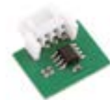
250SM126 Speichermodul, Speicherplatz für max. 126 Handsender
