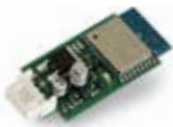
250T-WIFI Gerät für WIFI-Verbindung 2,4 GHz, mit dem die Verwendung des Smartphones zum Programmieren und Steuern der Steuereinheiten aus der Ferne über die TauApp ermöglicht wird
