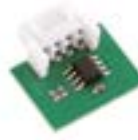
250SM126 Speichermodul, Speicherplatz für max. 126 Handsender
