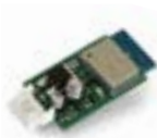
250T-WIFI Gerät für WIFI-Verbindung 2,4 GHz, mit dem die Verwendung des Smartphones zum Programmieren und Steuern der Steuereinheiten aus der Ferne über die TauApp ermöglicht wird
