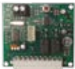
250RXSM2 2-Kanal-Funkempfänger 433,92 MHz, steckbar (Speicherplatz für 14 Handsender)
